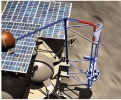
Перемещение образцов грунта в спускаемый annapat Soil samples transfer into the Descent module
